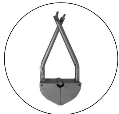
Figure 3 : Benne Van Veen (0.1 m<sup>2</sup>) fermée.
