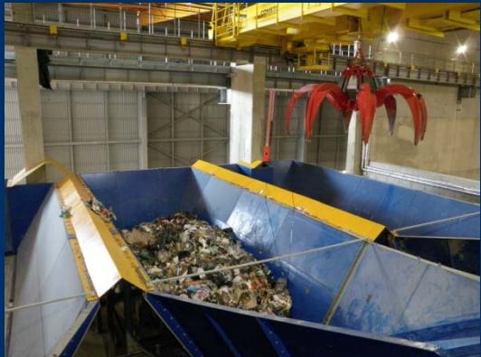
Grappins : Les ponts roulants à grappins des fosses d'OMR sont testés et opérationnels
